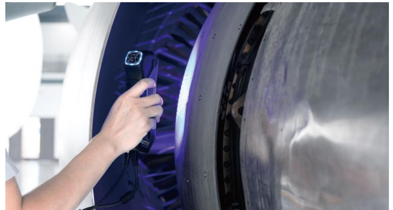
AXE-B17全局式三维扫描仪采用光学测量技术，测量速度2,000,000次/秒，快速获取物体三维数据，精准得出几何曲面上的偏差值。
